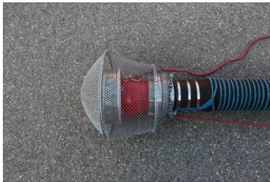
Wird die Saugleitung in stark strömendes Gewässer eingebracht so ist eine zusätzliche Halteleine am Saugkopf anzubringen, welche das Anschwemmen der Saugleitung ans Ufer oder das Abtreiben mit der Strömung verhindert. Bei mit Blättern verunreinigtem Wasser zusätzlich einen Saugschutzkorb anbringen.
