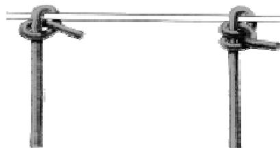
Sicherung mit einem - mit zwei halben Schlägen
