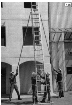
müssen immer beide Fallhaken auf einer Sprosse einrasten. Das Auszugseil wird über zwei Sprossen geschlagen und mittels Kreuzklank befestigt.
